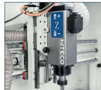
• Hochwertige Elektro-Frässpindel vom erfahrenen Hersteller Hiteco
