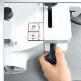
• Exakter Fräsanschlag mit einer Schnellverstellung und einer Feineinstellung mit Skala an der Anschlagbacke
