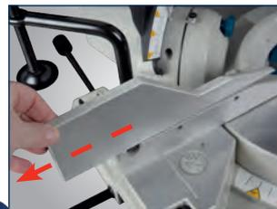
Ausziehbare Anschlagsschienen und ausziehbarer Tisch
