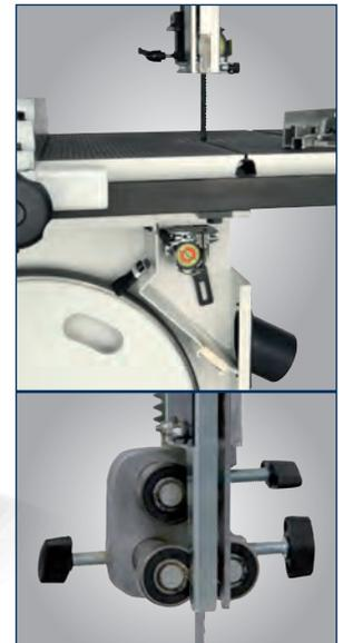
• Sägeband-Präzisionsführung oben und unten
