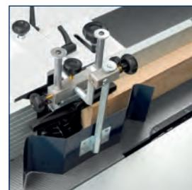
• Der Standard-Frässchutz ist für maximale Sicherheit serienmäßig mit einer höhenverstellbaren Führungsschiene und Schutzblech ausgestattet.
