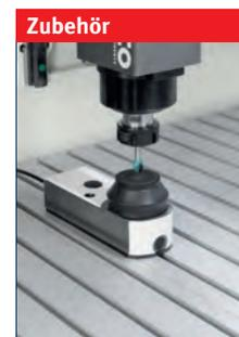
• Sensor zur Bestimmung der Werkzeuglänge
