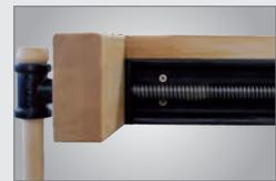
Massive Linearführung an der Hinterzange
