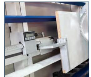
• Digitale Maßanzeige zur Längeneinstellung beim Vertikalschnitt
