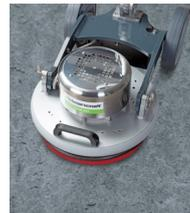
▶ Entwachsen und Aufpolieren von Vinylböden
