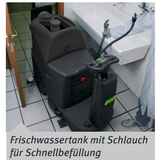
Frischwassertank mit Schlauch für Schnellbefüllung
