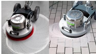
▶ Grundreinigung mit Wasser von Hart- und Vinylböden
