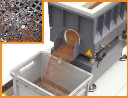
Separieren von Schleifkörpern und Werkstücken
