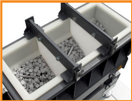
Trennwände - Bearbeitung empfindlicher Einzelwerk- stücke möglich
